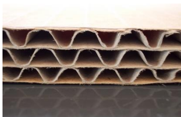
Triple cannelure : ultra résistante (15 mm)
