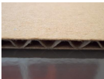
Simple cannelure : basique et solide (3 mm)
